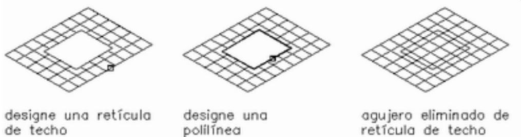
Supresión de un agujero de una retícula de techo
