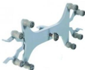
Esta pinza permite sujetar dos buretas al mismo tiempo, también las hay para una sola. Son fabricadas en hierro colado y latón con soportes de plásticos para no dañar la bureta; aunque en la actualidad por lo general las fabrican completamente de plástico
