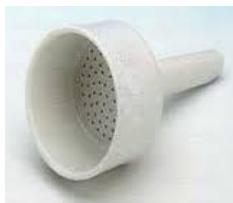
Son embudos de porcelana o vidrio de diferentes diámetros, su parte interna está conformada por orificios donde se coloca el papel de filtro. Se utiliza para realizar filtraciones al vacío.
