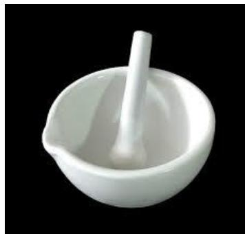
Son utensilios hechos de diferentes materiales como: porcelana, vidrio o ágata, los morteros de vidrio y de porcelana se utilizan para triturar materiales de poca dureza y los de ágata para materiales con mayor dureza.
