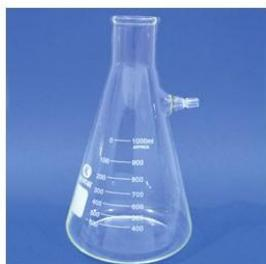
Es un matraz de vidrio que presenta un vástago lateral. Están hechos de cristal grueso para que resista los cambios de presión. Se utiliza para efectuar filtraciones al vacío.
