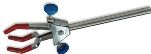
Estas pinzas permiten sujetar a diferentes tipos de refrigerantes. Cuando se utilizan para destilación, los ganchos dobles deben quedar en la parte de abajo para mejor sujeción del refrigerante.
