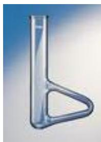
Es un utensilio de vidrio refractario que se utiliza para determinar puntos de fusión y ebullición.
