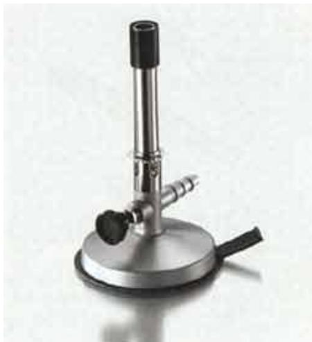
Es un utensilio metálico que permite calentar sustancias. Puede proporciona una llama caliente de hasta 1500 grados centígrados constante y sin humo, es por eso que se utiliza mucho en los laboratorios.
