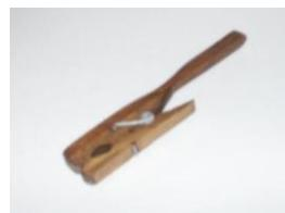
Permiten sujetar tubos de ensayo y si éstos se necesitan calentar, siempre se hace sujetándolos con estas pinzas, esto evita accidentes como quemaduras. Las hay de hierro y madera.
