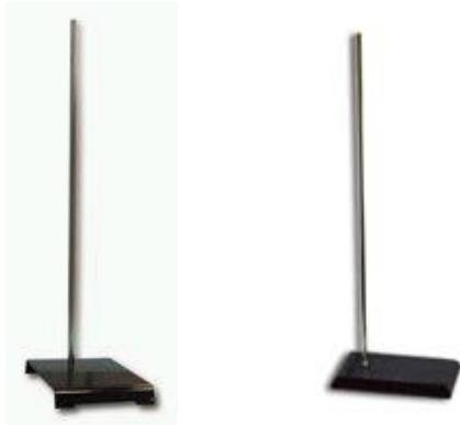
Es un utensilio de hierro que permite acoplar diferentes tipos de pinzas mediante dobles nueces, así como anillos de hierro y otros.
