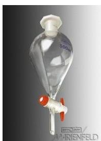
Es un embudo tiene la forma de un globo, existen en diferentes capacidades como: 100 mL, 250 mL, 500 mL, entre otros. Se utiliza para separar líquidos inmiscibles.
