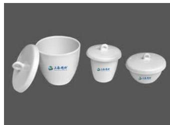
El crisol de porcelana es un utensilio de laboratorio utilizado principalmente para calentar, fundir, quemar, y calcinar sustancias, se utiliza con mucha frecuencia para llevar a peso constante una muestra en análisis gravimétricos.
