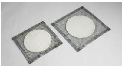
Es un material de alambre en forma cuadrada con la parte central recubierta de asbesto, con el propósito de lograr una mejor distribución del calor. Se utilizan para sostener utensilios que van a ser sometidos a calentamiento, tales como los vaso de precipitados, balón fondo redondo o fondo plano, entre otros.
