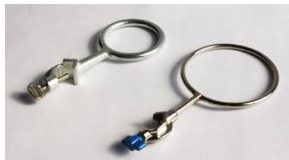
Los anillos de hierro se adaptan al soporte universal y sirven de soportes a otros utensilios tales como: Embudos de separación, entre otros. También son usados para calentar sustancias, colocándoles debajo del recipiente una malla con asbestos.
