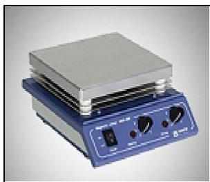
Este aparato tiene un agitador magnético y por esta razón permite calentar sustancias en forma homogénea.
