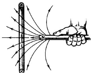
Vemos entonces que al acercar el imán, el flujo magnético que atraviesa la espira aumenta. Por lo tanto en la espira aparecerá una corriente inducida que produce un campo magnético en sentido contrario al del imán, dicha corriente aparece dibujada en la fig.
