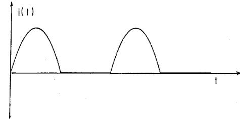
De esa forma se convierte una corriente CA en una corriente CC o sea una corriente alterna rectificada se convierte en una corriente continua oscilante.
