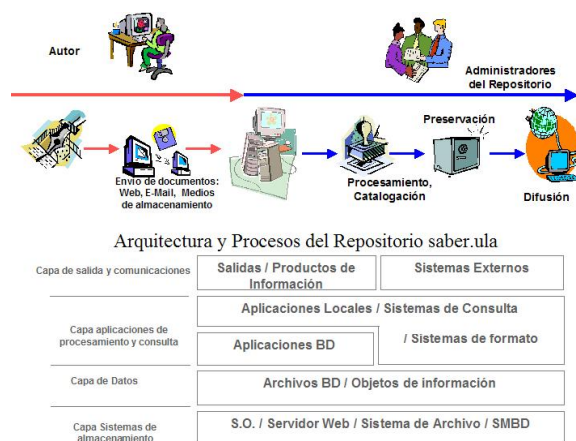
Figura 2: Arquitectura y Procesos del Repositorio. En la parte superior, se presenta los procesos que se siguen para la publicación y preservación de un documento en saber. En la parte inferior de la figura se muestra la arquitectura de información y servicios del servidor.
