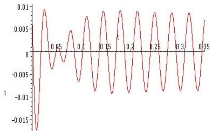
Figura 10: Intensidad de corriente en un circuito RLC sometido a un voltaje sinusoidal  $V(t) = \frac{1}{2} \cos(180t)$
