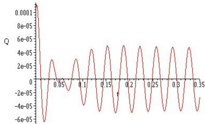
Figura 9: Carga en función del tiempo en un circuito RLC sometido a un voltaje sinusoidal  $V(t) = \frac{1}{2} \cos(180t)$ . Nótese el régimen transitorio ( $0 \leq t \lesssim 0,17$ ) y estacionario ( $t \gtrsim 0,17$ ).
