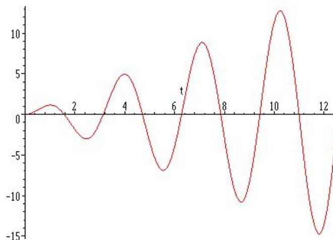
Figura 5: Oscilador armónico forzado con  $\varpi = \omega_0^2$  Nótese el fenómeno de resonancia
