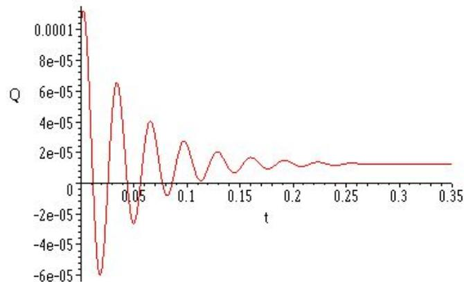
Figura 7: Carga en función del tiempo en un circuito RLC sometido a un voltaje constante. Nótese que el sistema alcanza el régimen estacionario cercano a los 0,3 sg
