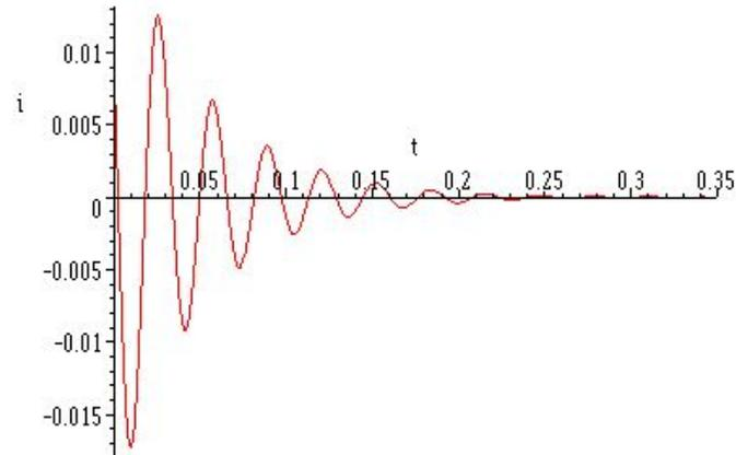
Figura 8: Intensidad en un circuito RLC sometido a un voltaje constante.
