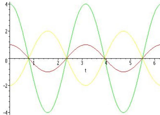
Figura 1: Oscilador armónico libre. Cambios en la posición inicial no afectan la frecuencia natural.
