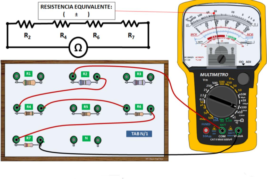
2.) RESISTENCIA EQUIVALENTE DE ARREGLO
