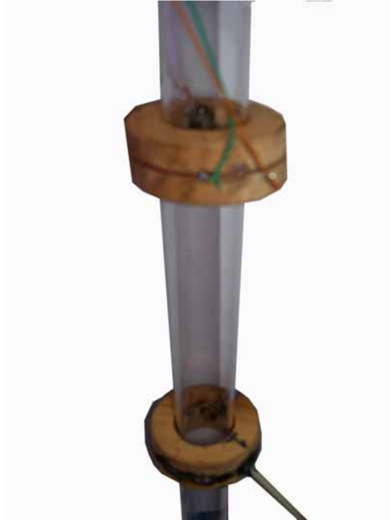
Figura # 4.10. Montaje de los dos cilindros de madera sobre el tubo de vidrio.
