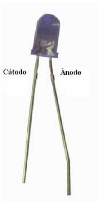
Figura # 4.7.a. Fotografía de LED IR comerciales utilizados en el experimento.
