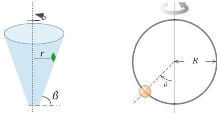
16. Una cuenta pequeña de masa  $m$  puede deslizarse sin fricción por un aro circular de radio  $R$  que está en un plano vertical. El aro gira con rapidez angular constante  $\omega$  en torno a un diámetro vertical. Calcule el ángulo  $\beta$  en que la cuenta está en equilibrio vertical.
