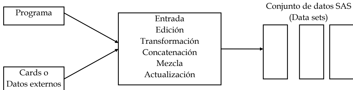
Fig. 23. Funcionamiento del paso de datos.
