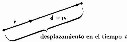
Figura 1.1.22 Desplazamiento = tiempo \times velocidad.
