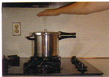
19.20 Vapor de agua caliente escapa con gran rapidez por la tapa de esta olla de presión. Por ello, casi no tiene tiempo de intercambiar calor con su entorno y su expansión es casi adiabática. Al aumentar el volumen del vapor, su temperatura baja tanto [vea la ecuación (19.22)] que se siente fresco en la mano de este chef.
