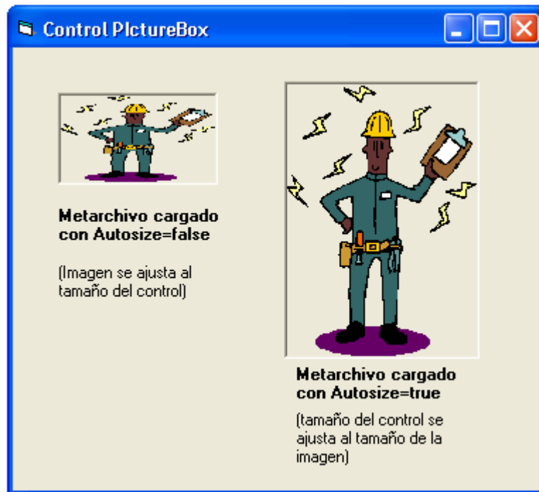
Figura 5.13. Efecto de la propiedad Autosize del control PictureBox con metarchivos.
