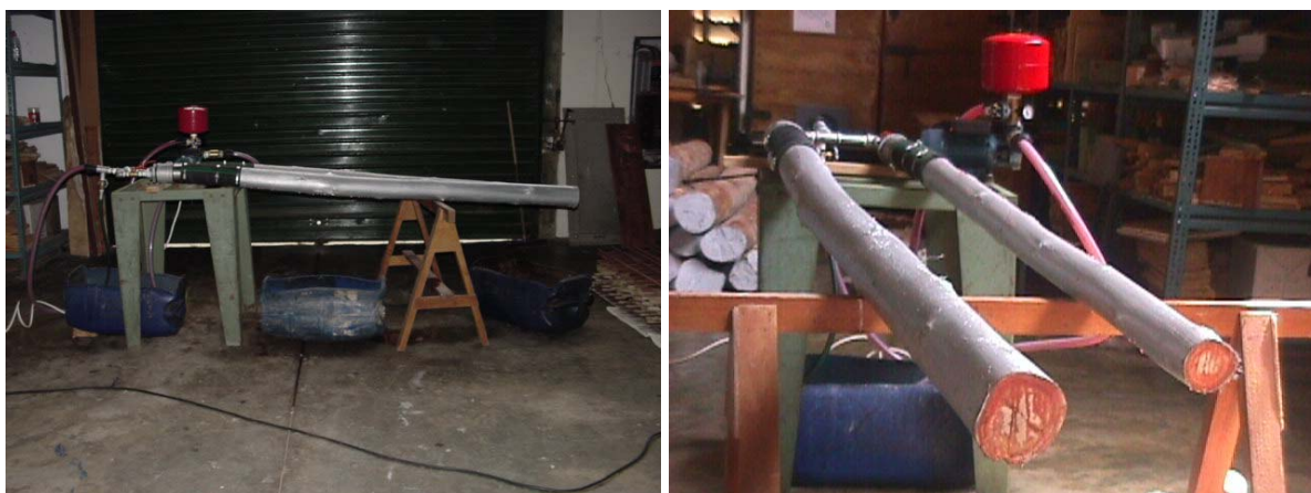
Figura 4. Rolas de eucalipto descortezado, recubiertas con pintura impermeable para simular la corteza y el prototipo del equipo diseñado para aplicar el método de desplazamiento de savia forzado ®
