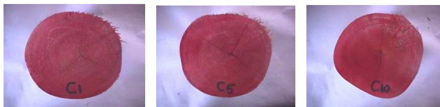
Figura 10. Secciones de una rola de eucalipto con pintura impermeable superficial, simulando corteza, tratadas con sales de boro, mostrando penetración regular total en toda la sección y a lo largo de toda la rola, obsérvese el color rojo intenso.
