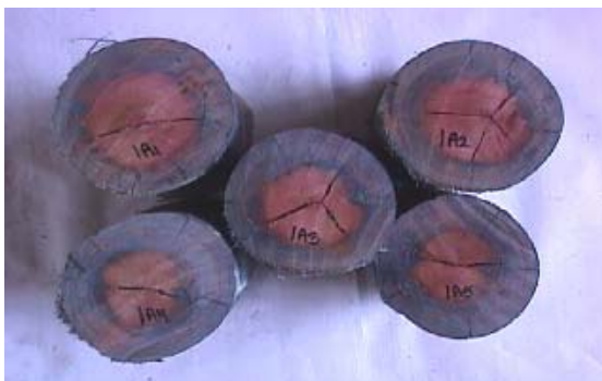
Figura 9. Secciones de rolas de teca mostrando la penetración total periférica del preservante, en este caso sal CCA. Obsérvese que la sección correspondiente al duramen no ha recibido preservante confirmando que esta porción de la madera de teca es refractaria a los tratamientos preservantes.
