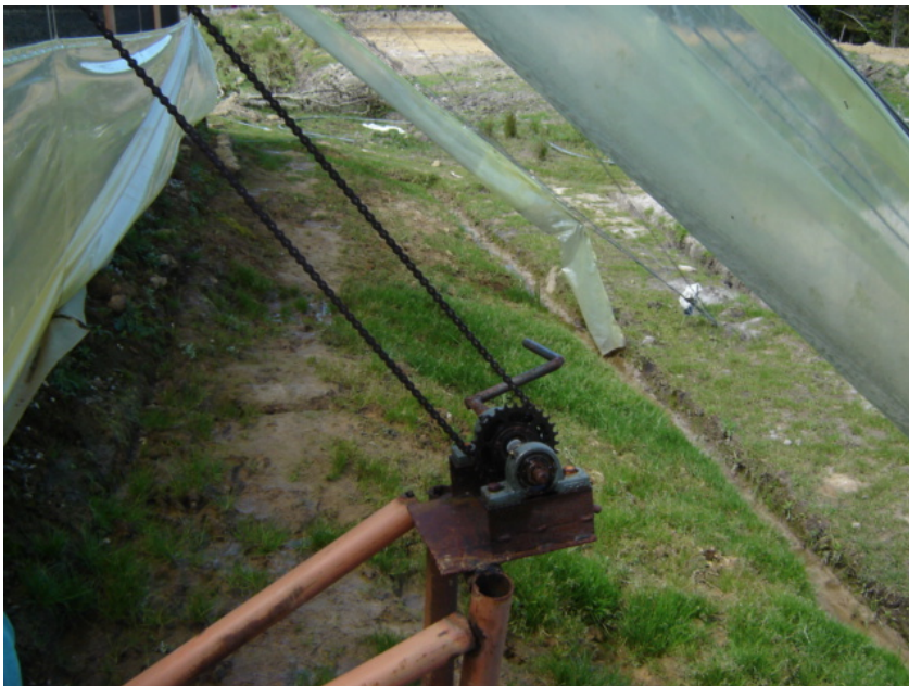
Figura 9. Detalle de transmisión por cadena y piñones con manivela para levantar ventanas laterales manualmente. Lugar: La Carbonera
