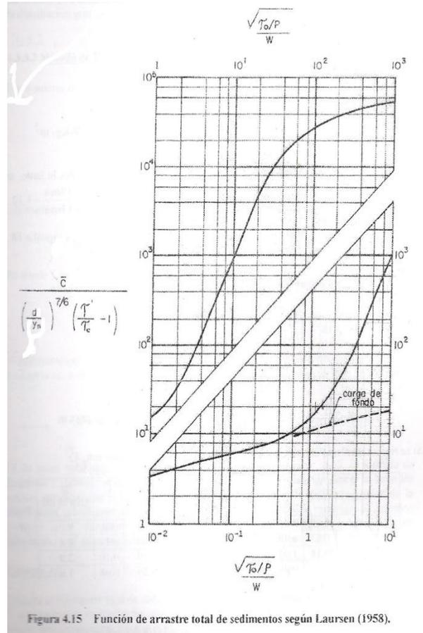
Figura 4.15 Función de arrastre total de sedimentos según Laursen (1958).
