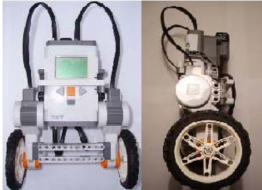
Péndulo invertido sobre dos ruedas utilizando la plataforma Lego Mindstorms NXT®, Héctor Sánchez (Noviembre, 2009)
