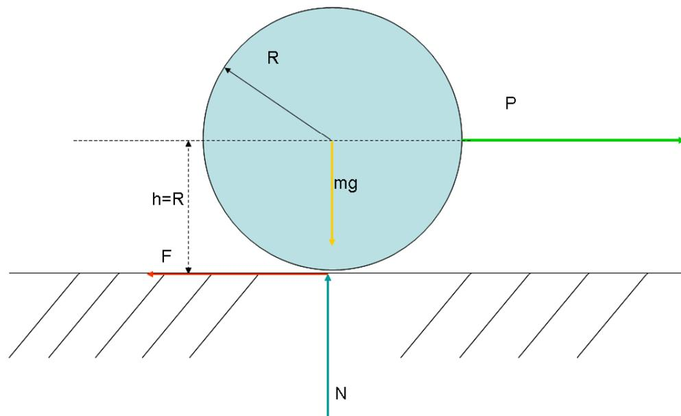
Las fuerzas  $mg$ ,  $P$  y  $N$  no producen torques en la ecuación de movimiento rotacional porque sus líneas de acción pasan por el centro de gravedad respecto del cual se da dicho movimiento de rotación.
