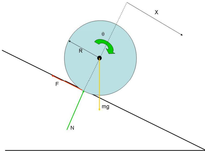
El cilindro se desliza si **no** existe fricción.
