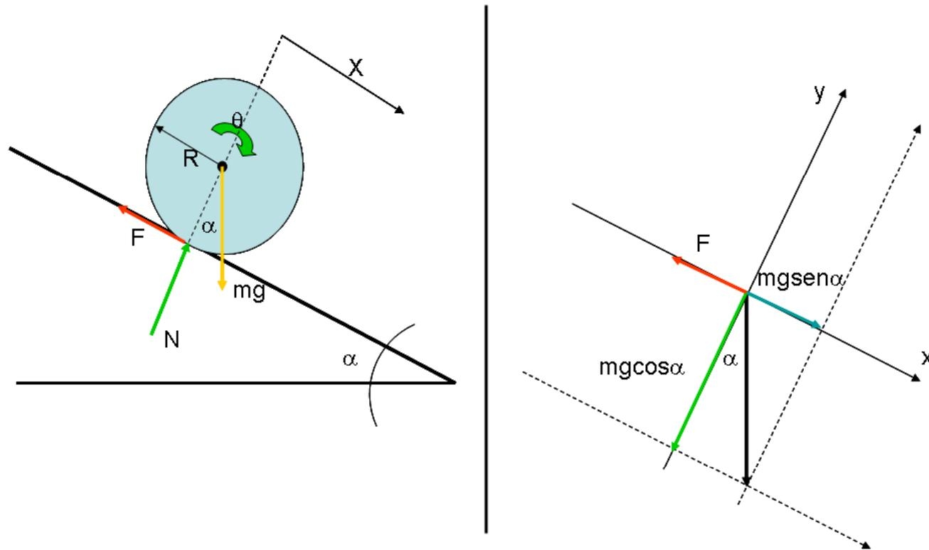
Según el ángulo  $\alpha$  el cilindro puede rodar o deslizar. Determinar  $\alpha$  para que el movimiento sea de **rodamiento**.
