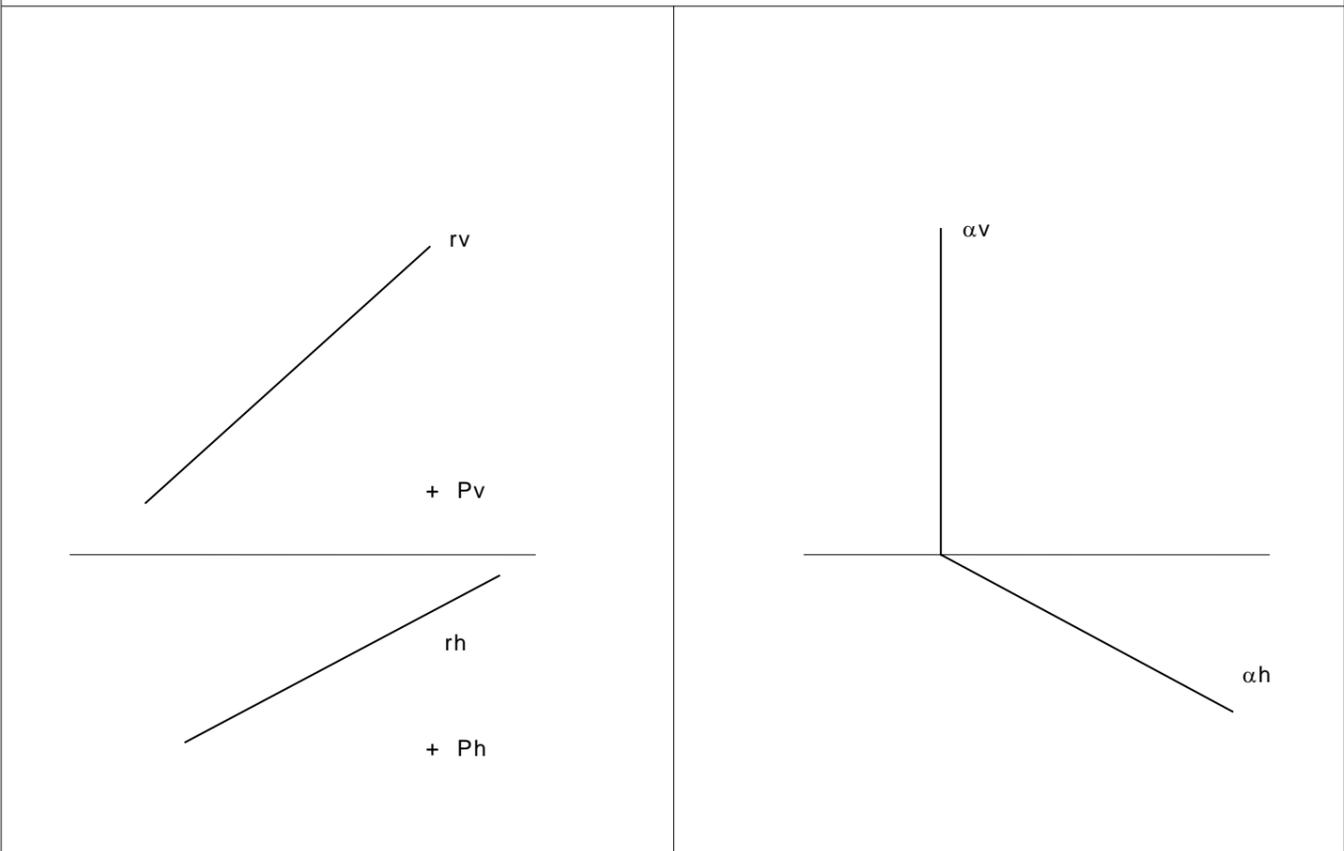
Dadas las rectas de máxima pendiente y máxima inclinación, determinar las trazas del plano que las contiene.
