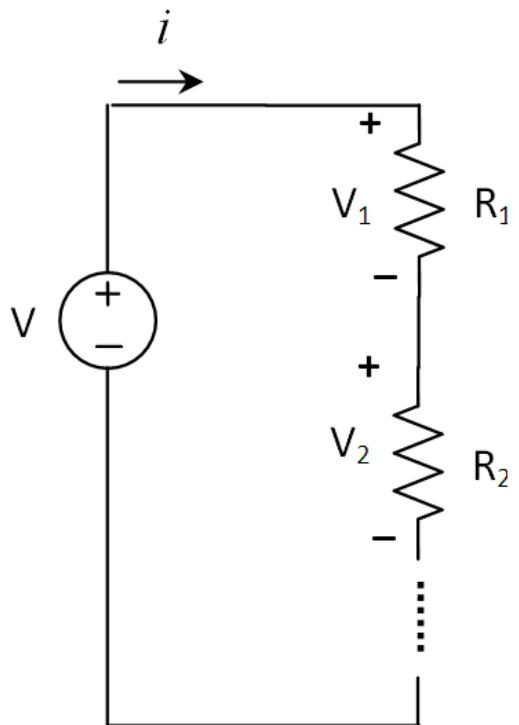
$$i = \frac{v}{R_1 + R_2 + \dots}$$
