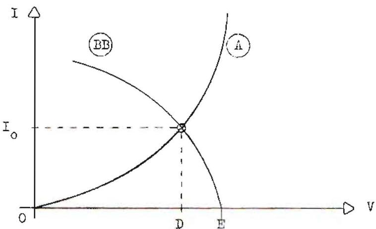
El valor OD es el voltaje terminal del elemento A, quedando el valor DE como voltaje terminal del elemento B. La corriente común en los dos elementos tendrá el valor  $I_o$ .
