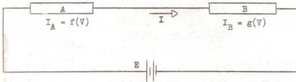
El primer elemento A tiene la relación  $I_A = f(V)$  y el segundo elemento B tiene la relación  $I_B = g(V)$ .
