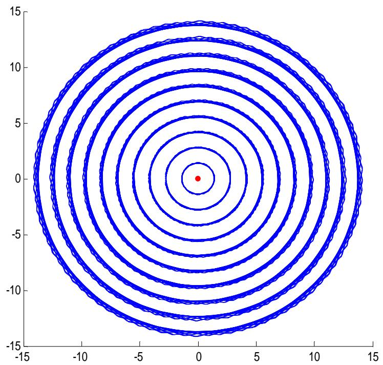
Ejemplo de un sistema no lineal (análisis de estabilidad según Lyapunov)
