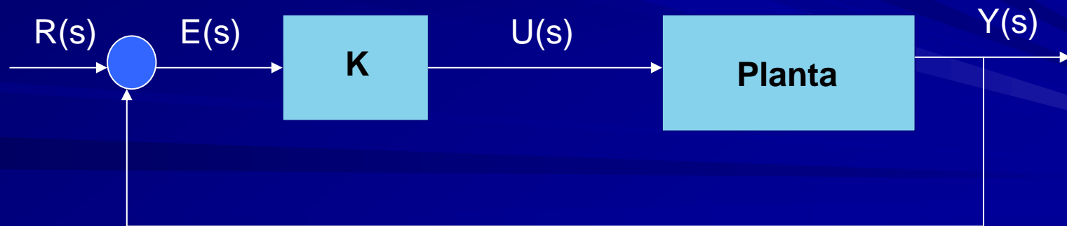
Figura 1. Diagrama de bloques de un sistema con realimentación unitaria
