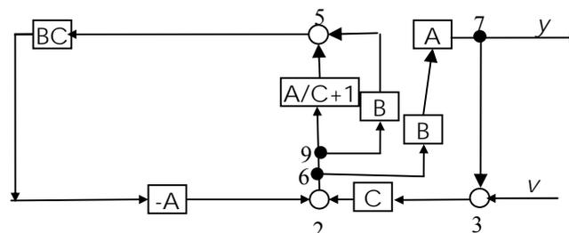
Resolvemos bloques paralelos entre puntos 9 y 5, y bloques serie A y B:
