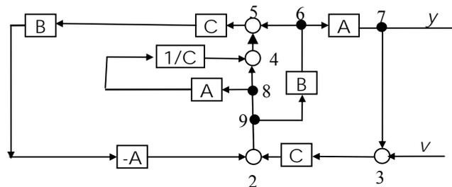
Resolvemos bloques paralelos entre puntos 4 y 8, y bloques en serie B y C, movemos punto de ramificación 6 antes de bloque B e intercambiamos con 9:
