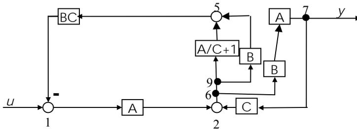
Resolvemos bloques paralelos entre puntos 9 y 5, y bloques serie A y B:
