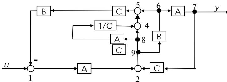
Resolvemos bloques paralelos entre puntos 4 y 8, y bloques en serie B y C:
