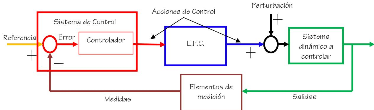
En este las acciones de control son calculadas por la medición de las salidas (variables controladas), este tipo de control suele denominarse control por retorno de salida.
