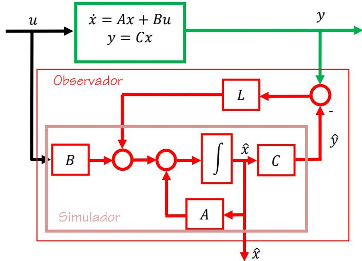
El cálculo de un observador para un sistema LTI consiste entonces en calcular la matriz  $L$ , para obtener unos valores propios del sistema retroalimentado (observador) en una posición seleccionada arbitrariamente. Se dice entonces que se trata de un problema de control modal del sistema dual.
