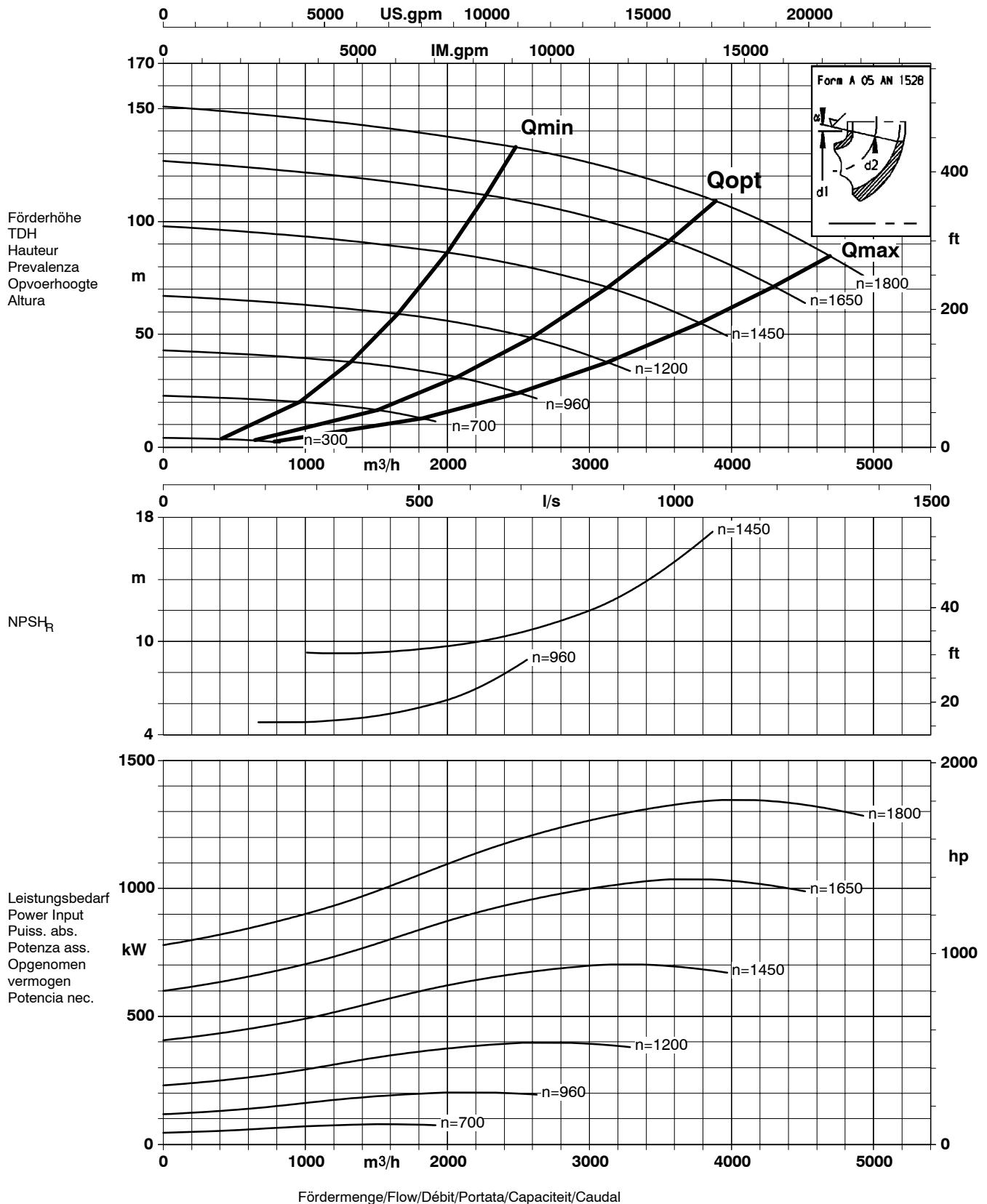
Laufraustrittsbreite/Impeller outlet width/Largeur à la sortie de la roue 82 mm
