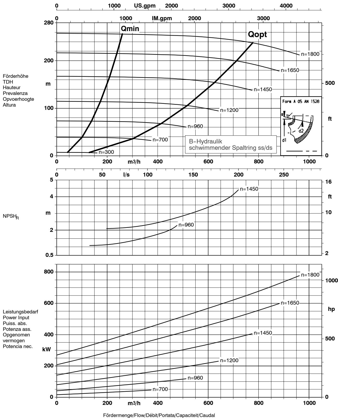
Laufradaustrittsbreite/Impeller outlet width/Largeur à la sortie de la roue 26 mm
