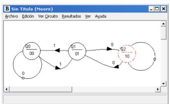
Programa de captura de sistemas digitales "Boole-Deusto": Obtener un circuito flip-flops JK a partir de un diagrama de Moore automáticamente.
