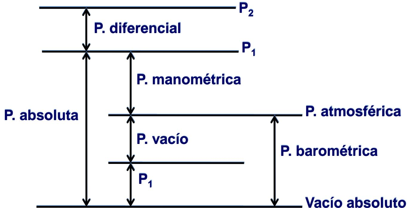
Ilustración de las lecturas de presión absoluta, manométrica y de vacío
