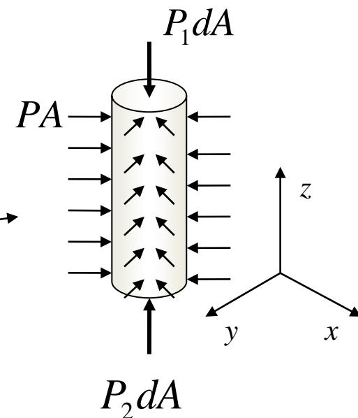
Si suponemos que el cuerpo está formado por elementos de volumen de forma cilíndrica, se tendrá que la fuerza neta aplicada sobre cada elemento cilíndrico será igual a la sumatoria de las fuerzas de presión aplicadas.
