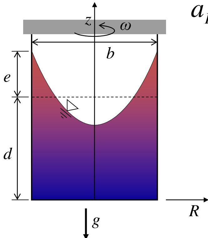
Por lo tanto solo existe aceleración en la dirección radial  $R$ . De esta manera la presión en el fluido se puede expresar con solo dos componentes una radial y una vertical:
