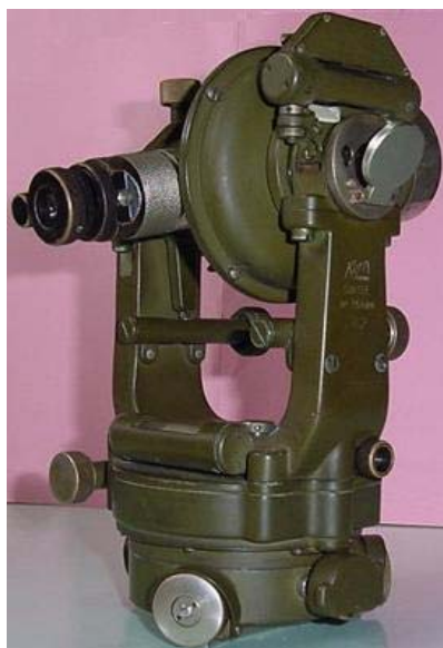
Figura 2.21. Teodolito Kern DK-2 con sistema de lectura de coincidencia
