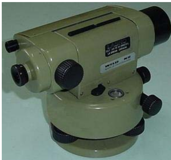
Figura 2.28. Nivel Wild N2 con nivel tórico de doble curvatura
