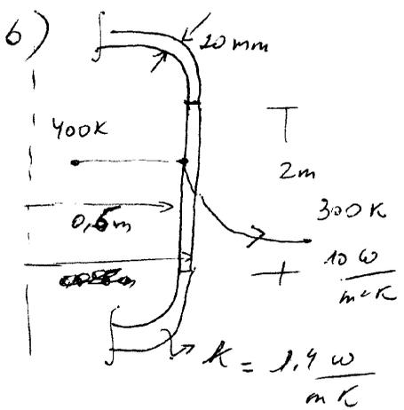
El problema puede resolverse desobviando de las resistencias de las caras diciendo que las caras están en paralelo con el cuerpo cilíndrico del tanque
