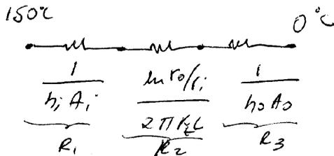
No se tiene  $k_c$  del tubo, pero como es metálico y de pared delgada, se puede suponer que la resistencia conductora es despreciable,  $R_2 \rightarrow 0$ .
