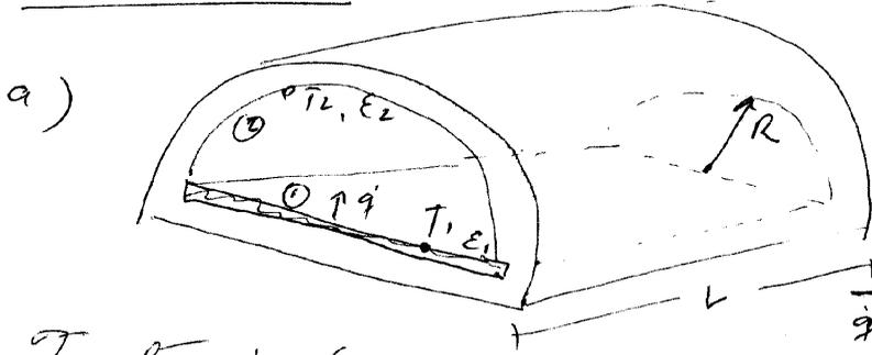
Se supondrá que el conducto es muy largo y que está al vacío. Circuito radiante:
