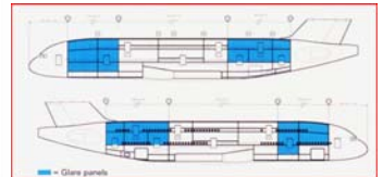
Figura 130 Materiales reforzados con láminas utilizados en aplicaciones aeronáuticas y aeroespaciales. El compuesto laminar GLARE es utilizado en el recientemente desarrollado avión A380.
