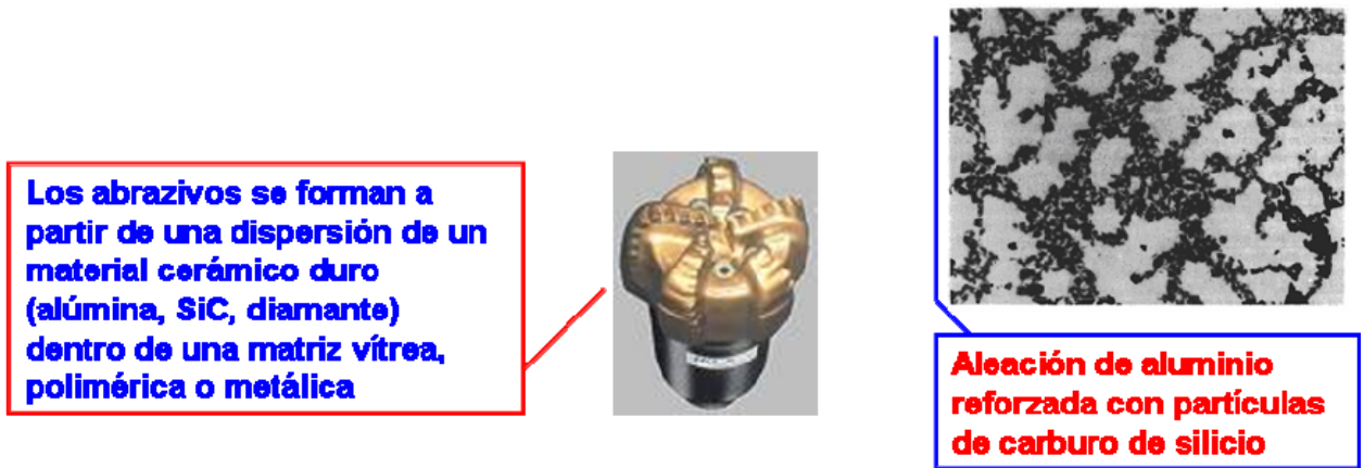
Figura 122 Compuestos reforzados por dispersión utilizados en barrenas de perforación. A medida que las partículas duras se desgastan, se rompen o salen de la matriz, y se exponen nuevas superficies de corte.
