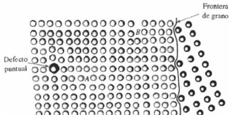
Figura 40 Si la dislocación en el punto A se mueve hacia la izquierda, será bloqueada por el defecto puntual. Si se mueve hacia la derecha, entrará en interacción con la red desorganizada cerca de la segunda dislocación en el punto B. Si se mueve aún más hacia la derecha, quedará bloqueada por el borde de grano
