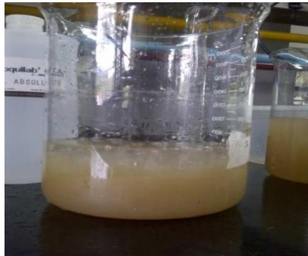
**Fotografía 3: separación de las dos fases después de agregarle etanol al 80%**
