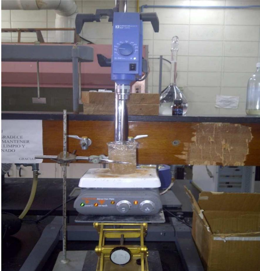
**Fotografía 5: mezclado con agitador para obtención de producto**
