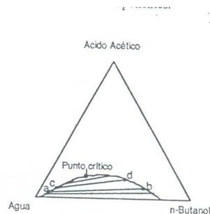
Figura 2: Diagrama de Solubilidad del sistema ácido acético/n-butanol/agua.
