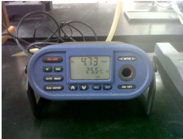
Figura N°8 Equipo para la medida de oxígenos disueltos en las muestras.
