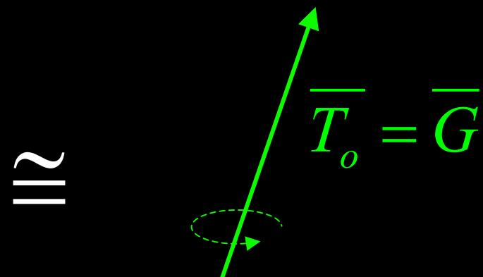
El efecto que produce el sistema general de fuerzas dado es de **Rotación** en la dirección del par  $T_o$ .
