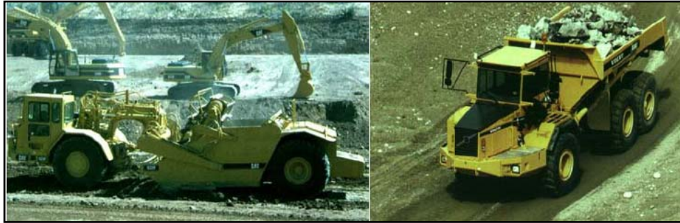
Fig. 6. Maquinaria empleada en el transporte y extendido de tierras. [BAÑON, L., BEVIÁ, JF. (2000)]
