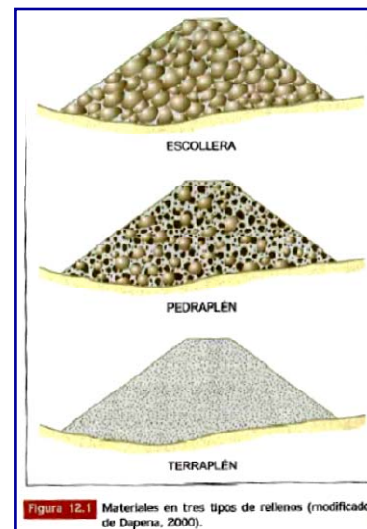
Fig. 2. Tres tipos de Rellenos. [BAÑON, L., BEVIÁ, JF. (2000)]
