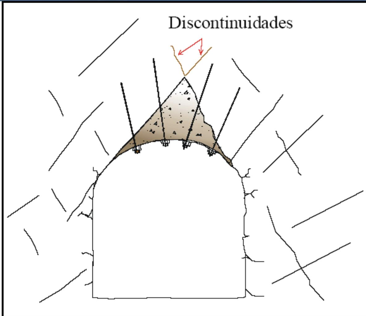
Bulones de anclaje soportando un bloque de roca en un túnel excavado a través de un macizo rocoso.
