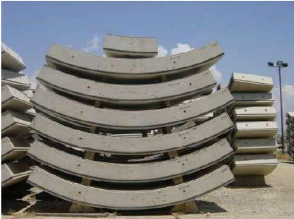
Conjunto de dovelas que conforman el anillo que reviste el túnel
