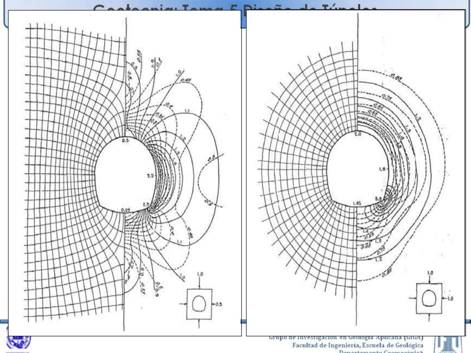
Representación del estado de tensiones en clave y hastial derecho para el túnel, siendo K = 0
