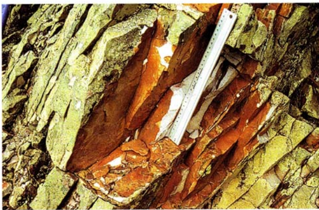
Fig. 12 - Alteración por oxidación en las superficies de discontinuidad de un macizo rocoso de cuarcitas, mientras que la matriz rocosa permanece fresca.
