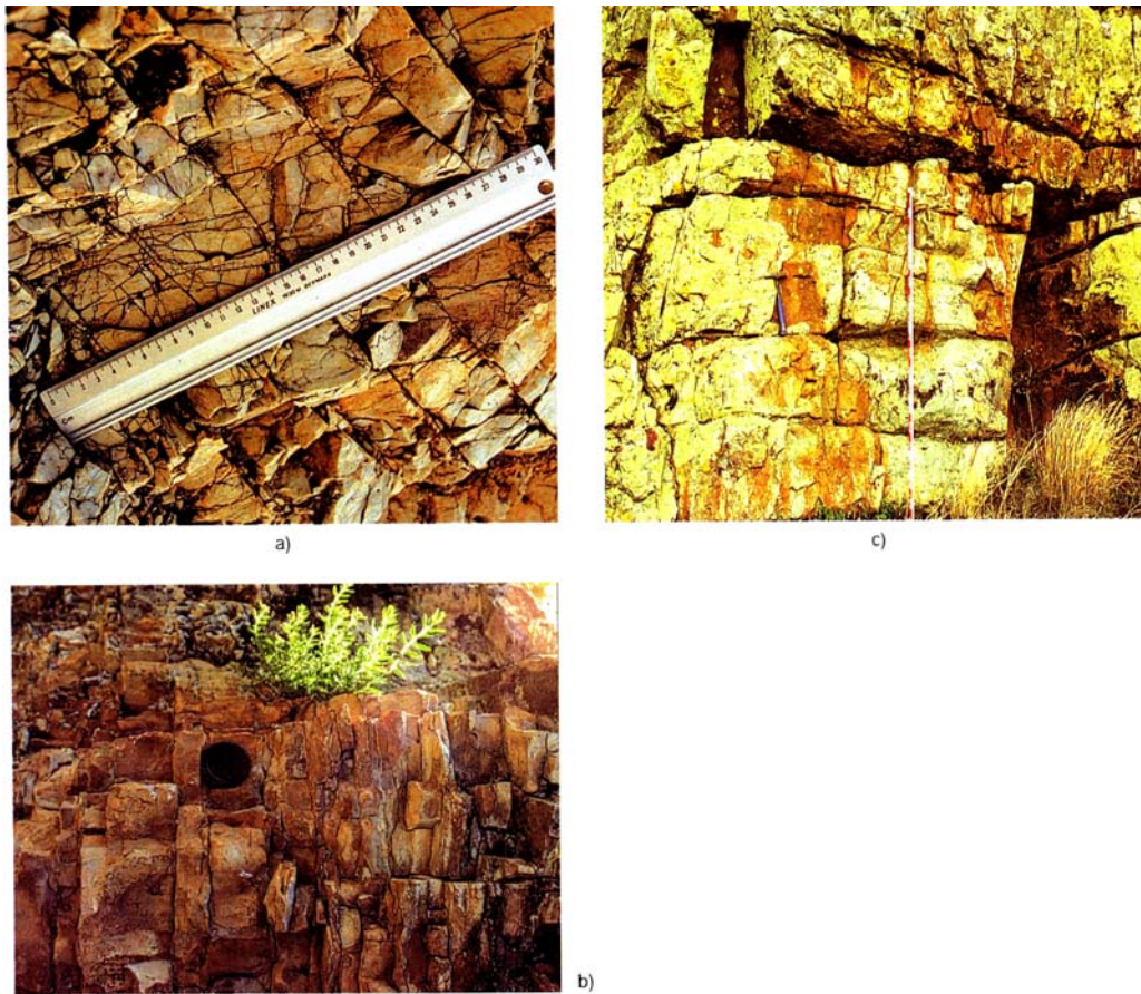
Fig. 8 - Ejemplos de espaciados de discontinuidades en afloramientos. a) Espaciado «muy junto» (5 cm) en la familia principal de discontinuidades con dirección perpendicular a la regla; b) Macizo calizo con dos familias principales de discontinuidades, una vertical con continuidad «media» y una horizontal con continuidad «muy baja», ambas con espaciado «muy junto» y formando bloques «muy pequeños»; c) Macizo cuarcítico de buena calidad con discontinuidades horizontales y verticales «separadas», con espaciados del orden de 0,5-1 metro.
