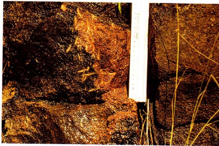
Fig. 16 - Circulación de agua a favor de discontinuidades en un macizo rocoso muy meteorizado de areniscas (cortesía de Prospección y Geotecnia).
