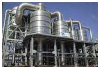
Concentración del jugo de tomate por el evaporador fraccional continuo ULTER2200/F funcionamiento en vacío a circulación forzada en 3 efectos con capacidad de 2.200 T/24 h. (Rio Bravo - California - U.S.A. 2000).
