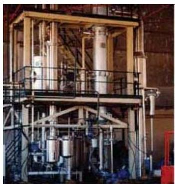
Evaporador turbulento de película delgada TTFE-1/800 para jugo de fruta tropical sensible al calor y concentración de pures con recuperación de aromas por condensación, concentración, reintroducción.
