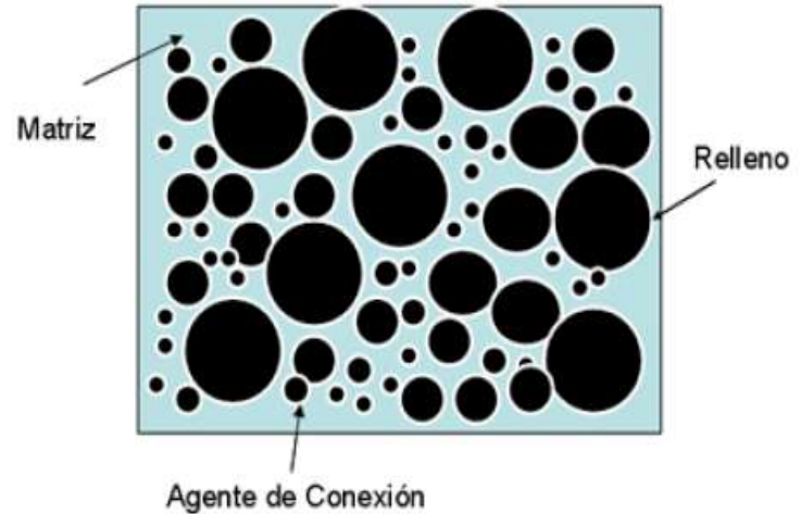
Fig. N° 2. Componentes fundamentales de las resinas compuestas. Esquema general donde puede verse la matriz de resina, las partículas de relleno y el agente de conexión.
