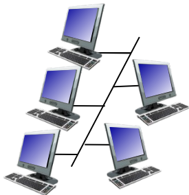
Cableado compartido (Ethernet)
