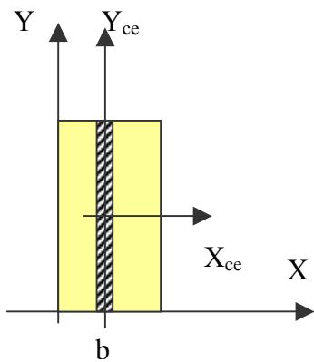
De acuerdo al teorema de los ejes paralelos para el producto de inercia es  $I_{xy} = \bar{I}_{xy} + xyA$ , aplicando dicho teorema a un diferencial de área se tiene:  $dI_{xy} = d\bar{I}_{xy} + xydA$ . Como el diferencial de área ( $dA = h*dx$ ) (rectángulo rayado) es simétrico respecto a sus ejes centroidales ( $X_{ce}, Y_{ce}$ ), el valor del producto diferencial de inercia centroidal es nulo,  $d\bar{I}_{xy} = 0$ . Los valores de  $x$  e  $y$  se
