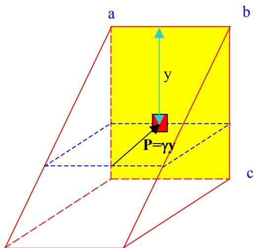
El momento respecto a el eje AB debido a la fuerza ejercida sobre el elemento  $dA$  es  $dM = dF * y = P dA * y = (\gamma y dA) y = \gamma y^2 dA = \gamma (y^2 dA)$ . El momento total sobre la superficie ABCD,  $M$ , es la suma de todos los momentos diferenciales  $dM$ .
