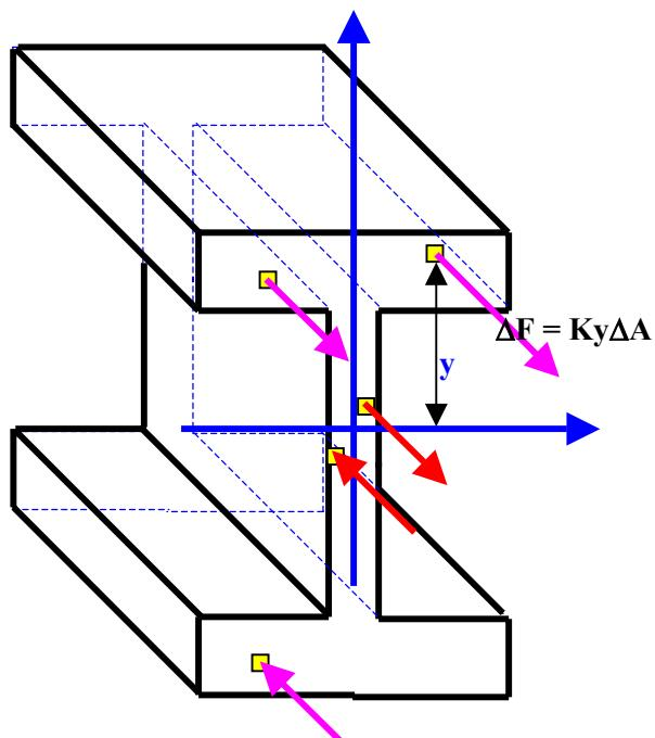
**Nota : El eje que pasan a través del centroide de la sección se llaman Eje Neutro ó Eje centroidal.**
