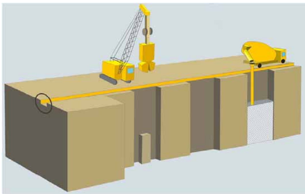
Fig. 15: Presa Limón/Olmos. Proceso de vaciado de diafragma (cortesía ODEBRECHT).
