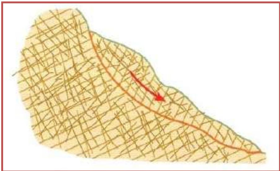
Rotura circular en roca muy fracturada sin sistema de discontinuidad identifiable.
