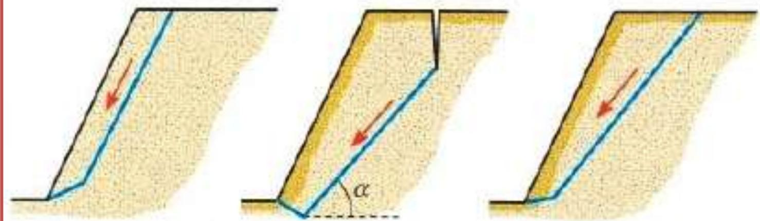
Rotura paralela al talud
