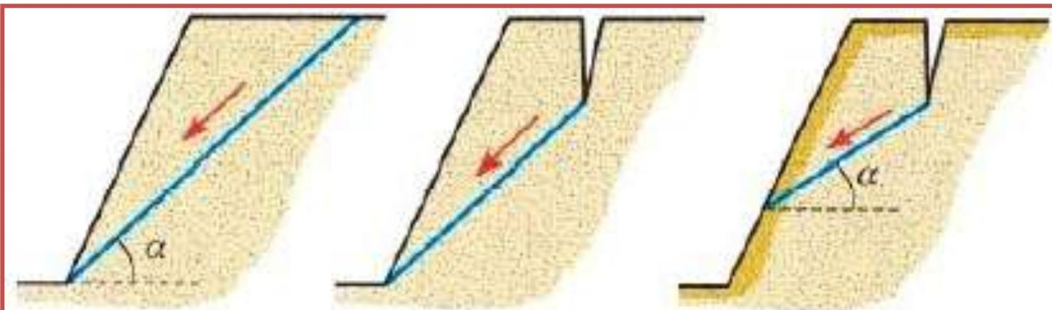
Plano único de rotura aflorando en el pie o en la cara del talud
