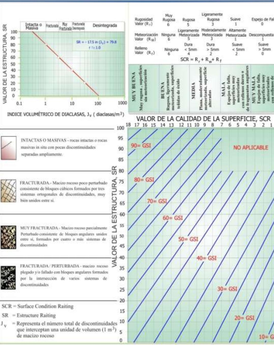
ESTIMACIÓN DEL GSI SEGÚN SÖNNMEZ Y ULUSAY (2002), PARA EVALUAR LA CALIDAD DEL MACIZO ROCOSO EN FUNCIÓN DEL GRADO Y LAS CARÁCTERISTICAS DE FRACTURACION, ESTRUCTURA GEOLÓGICA, TAMAÑO DE LOS BLOQUES Y ALTERACIÓN DE LAS DISCONTINUIDADES
